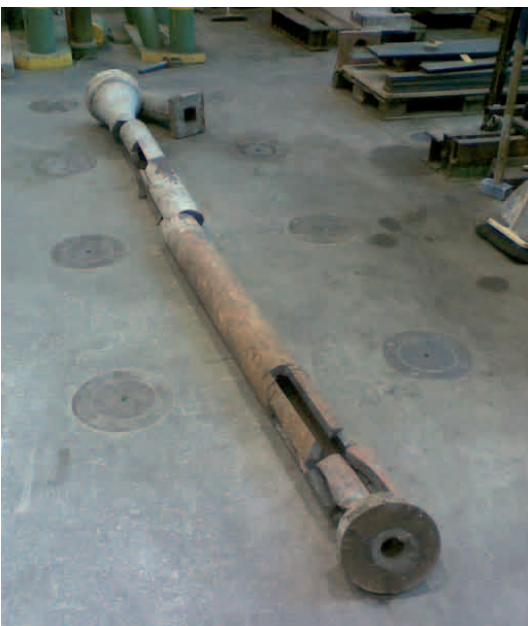
Oben: Bauteilversuch Gussstütze
