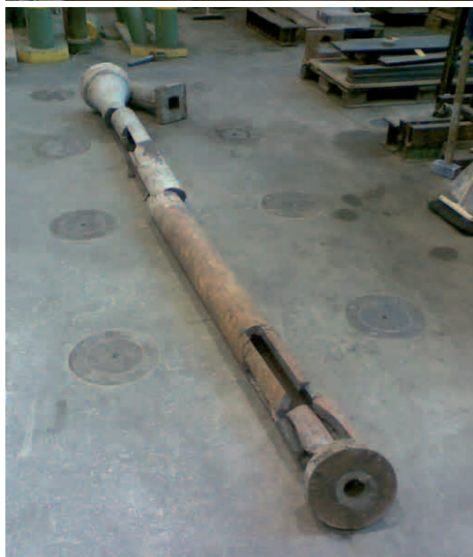
Oben: Bauteilversuch Gussstütze
